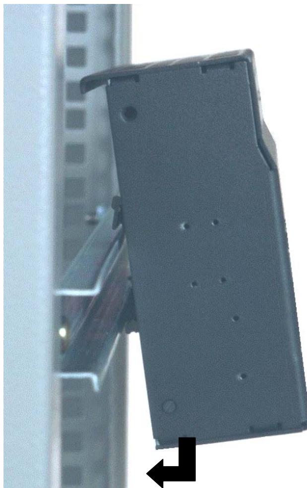
Рисунок 3: Установка модуля ОМС на стандартную DIN рейку
