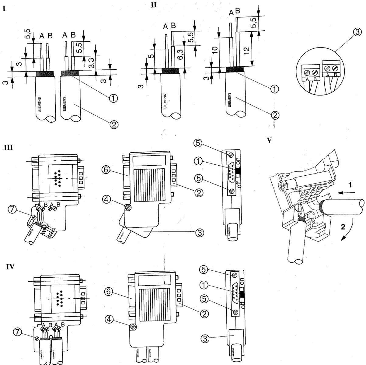
Рис. I: Подключение шины для вертикального отвода кабеля.
