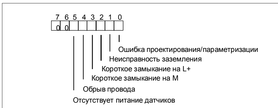
Рис. В-4. Диагностический байт для канала цифрового ввода SM 321; DI 16 × 24 VDC
