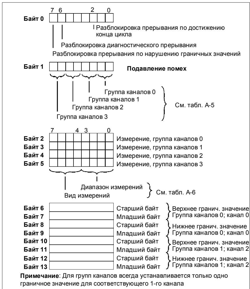
Рис. А-3. Запись данных 1 для параметров аналоговых модулей ввода
