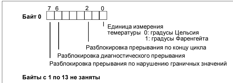
Рис. А–8. Запись данных 1 параметров для SM 331; AI 8 × TC
