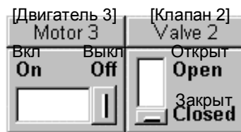
Рис. 5–4. Выключатели с различной ориентацией
