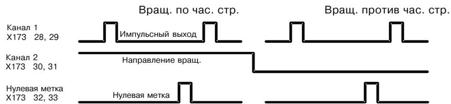
P141 Количество импульсов датчика (импульс/оборот)
