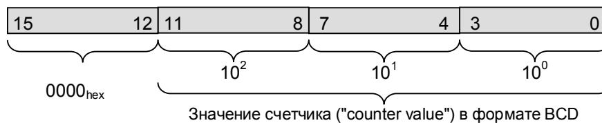
Рис. 8.1 Назначение битов для значения счетчика ("counter value")
