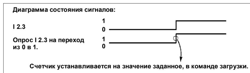
Рис. 7–2. Установка счетчика
