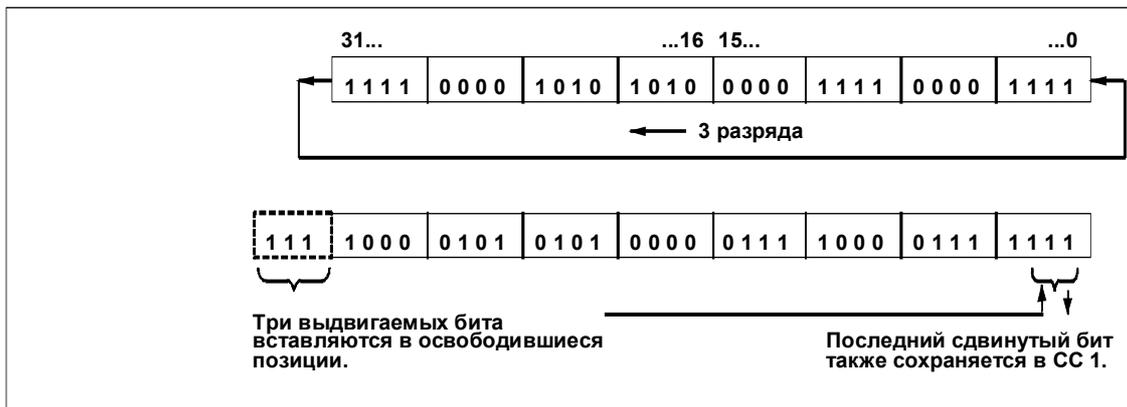
Рис. 14–4. Циклический сдвиг битов аккумулятора 1 на три разряда влево
