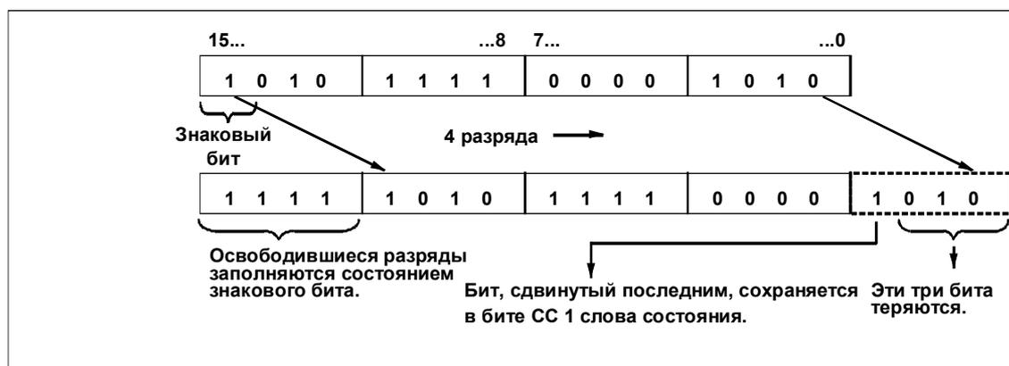
Рис. 14–3. Сдвиг битов младшего слова аккумулятора 1 на четыре разряда вправо со знаком
