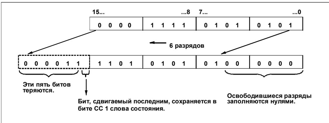
Рис. 14–1. Сдвиг битов младшего слова аккумулятора 1 на 6 разрядов влево
