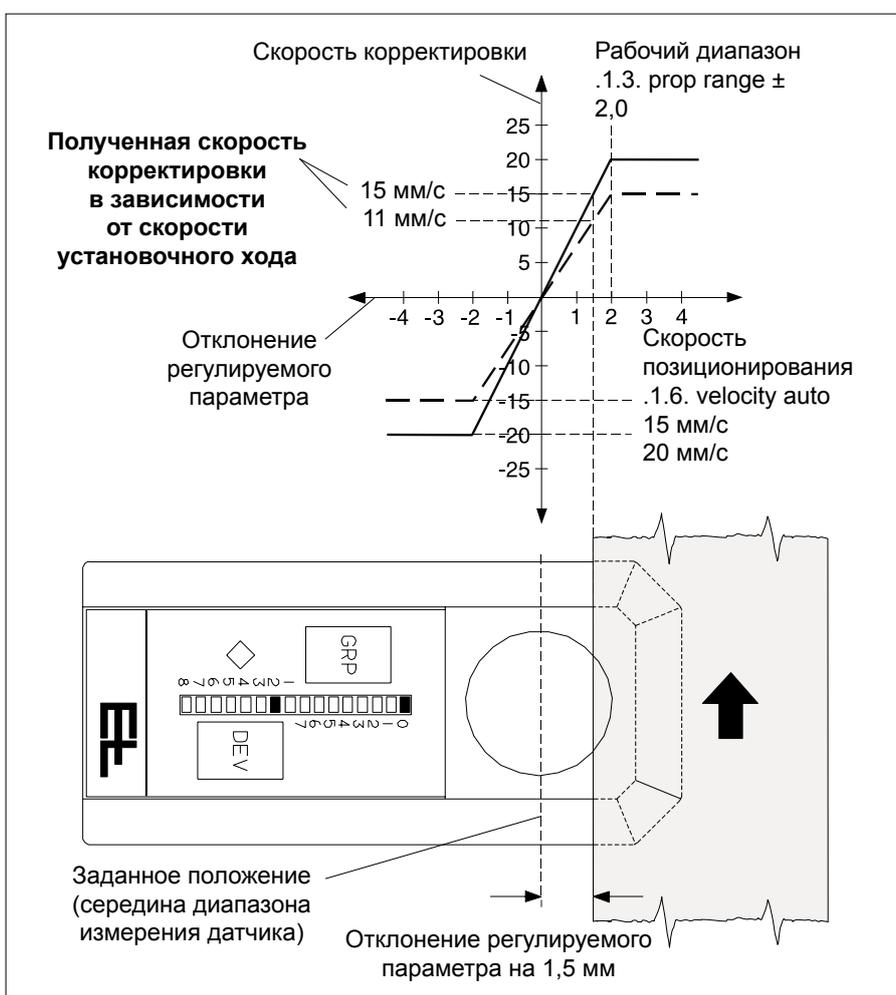
Увеличивая максимальную скорость позиционирования, характеристическая кривая становится более крутой (см. рис.). Чем круче кривая, тем больше скорость позиционирования при отклонении регулируемого параметра и, соответственно, более чувствительной становится установка. При помощи характеристической кривой можно узнать с какой скоростью позиционирования исполнительный элемент пытается исправить погрешность.
